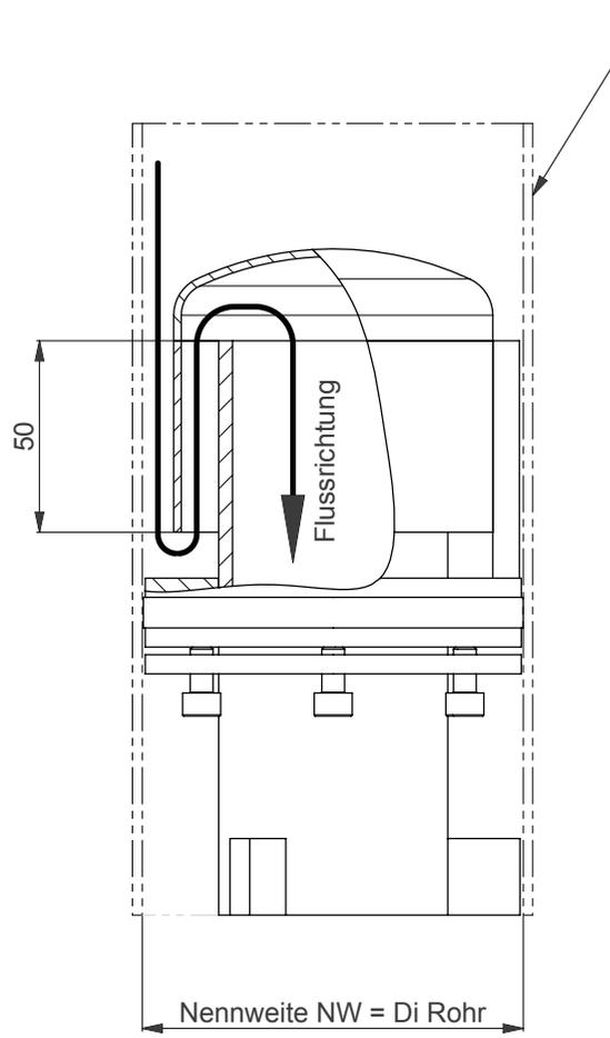
Rohr von Ab- und Überlaufventil
